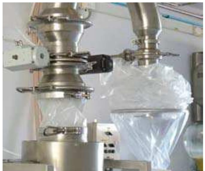
Dettaglio sistema di dosaggio anello gonfiabile e liner continuo
