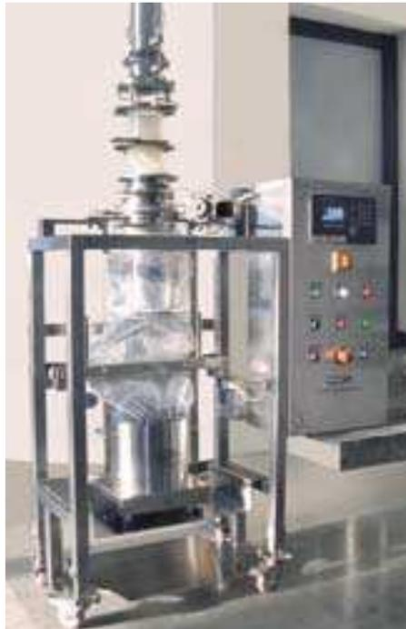
Sistema dosaggio liner continuo, scarico e dosaggio tappi da autoclave
