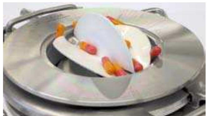
Dettaglio ROTARY VALVE TABLET con capsule
