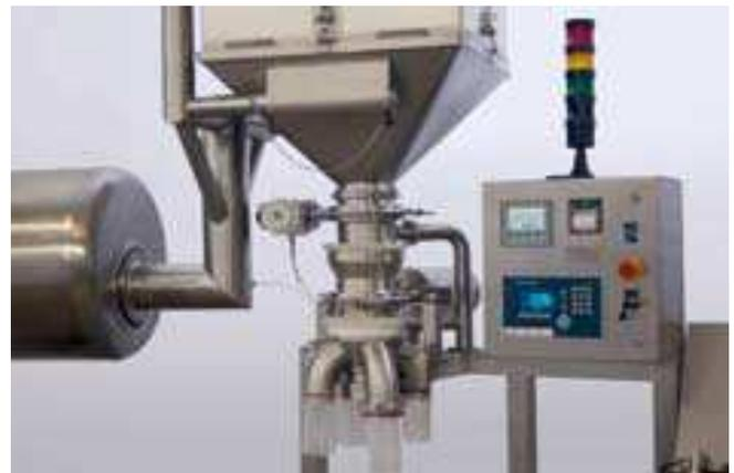
Dettaglio sistema di dosaggio capsule e compresse
