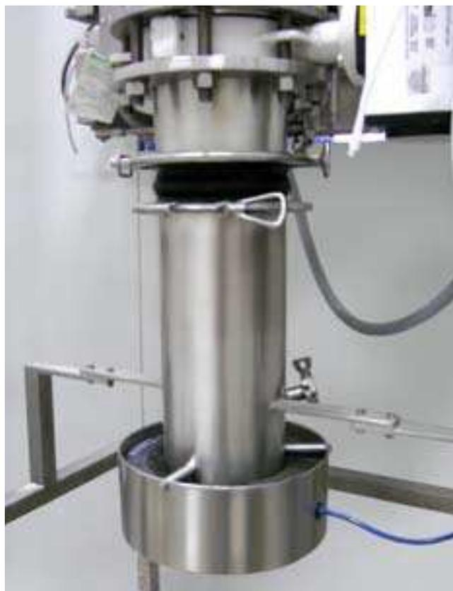
Dettaglio sistema di dosaggio ad anello gonfiabile
