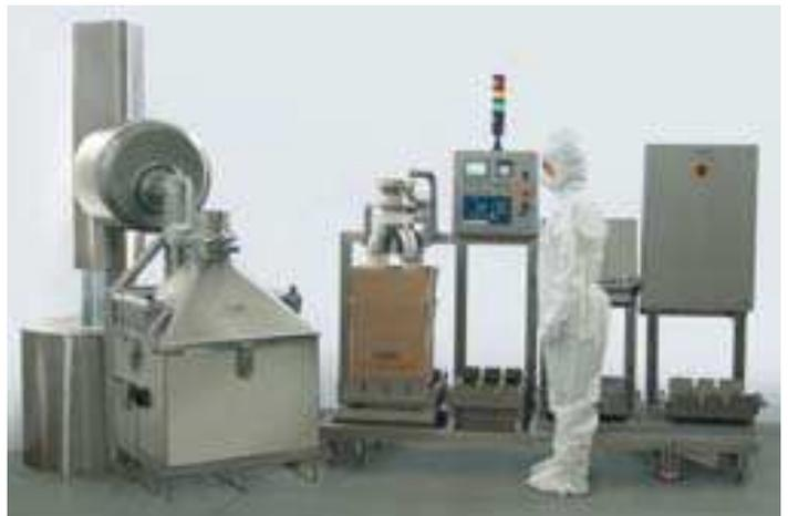
Sistema di dosaggio capsule e compresse con STERI LIFT
