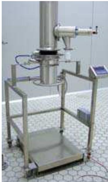
Sistema dosaggio liner continuo, scarico e dosaggio da essiccatore
