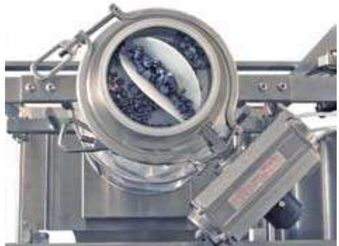
Dettaglio ROTARY VALVE TABLET con tappi in silicone
